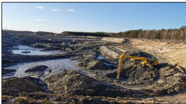
Ryc. 5. Eksploatacja metodą punktowo – kominową (brak jednolitego frontu eksploatacyjnego).
