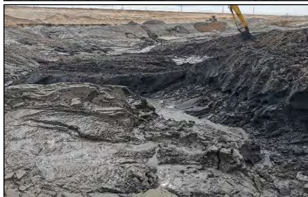
Ryc. 7. Zaciskanie się górotworu z powodu braku osuszenia złoża w części glaukonitonośnej.
