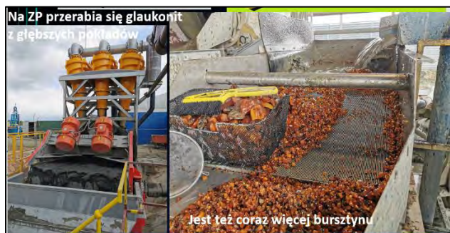
Ryc. 11. Przerabianie glaukonitu z głębszych pokładów.
