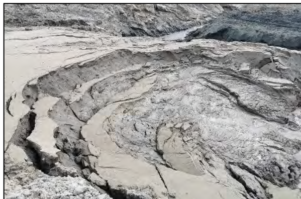
Ryc. 5. Eksploatacja metodą punktowo – kominową (brak jednolitego frontu eksploatacyjnego).
